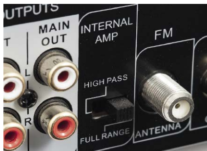
Jednym z nich jest sekcja filtrów dolno- i górnoprzepustowych, ułatwiających zestrojenie systemu kolumn z subwooferem.
